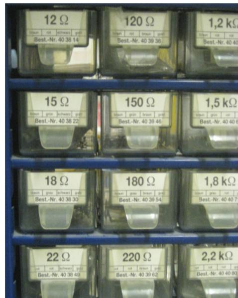
Box mit Widerständen für den Bau elektronischer Schaltungen
