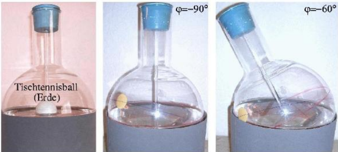
Abbildung 2: Oben: Bestandteile des Flaschenglobus. Unten links: Die Erde „vererbt“ der scheinbaren Himmelskugel den Äquator (Himmelsäquator) und die Rotationsachse (Polachse als Achse der scheinbaren Rotation). Unten rechts: Flaschenglobus zur Demonstration des täglichen (und jährlichen) Sonnenlaufs am Südpol ( \varphi = -90^\circ ) und bei der südlichen geografischen Breite von \varphi = -60^\circ . Der Folienstreifen mit der blau angedeuteten Ekliptik und der Sonnenapplikation wurde so eingestellt, dass die Sonne gerade ihre größte südliche Deklination erreicht hat, d. h. auf der Südhalbkugel der Erde ist gerade Sommeranfang. In der linken Darstellung ist die Sonne gerade über dem Westhorizont erschienen, d. h. sie ist gerade aufgegangen. Die rechte Einstellung gilt für den Südpol. Die Sonne kulminiert dort bei Sommeranfang. ©: Olaf Fischer, CC0.
