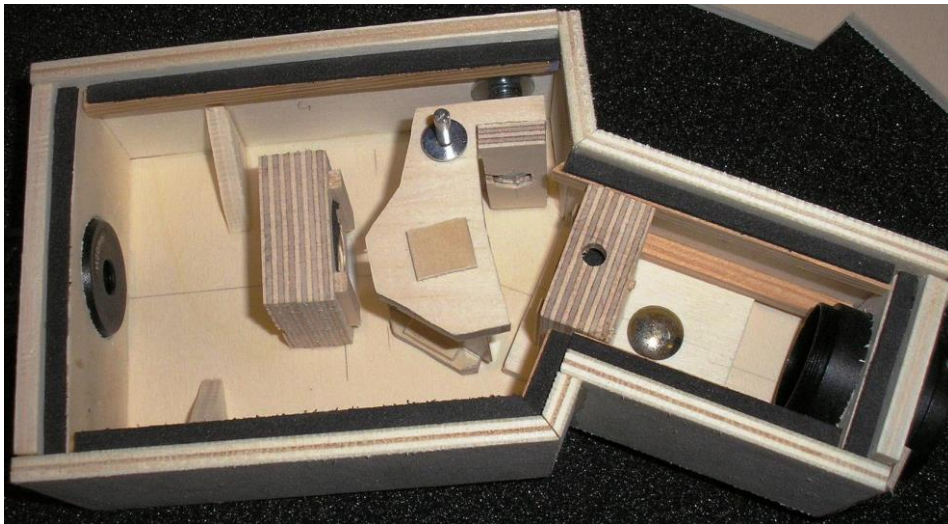
Prismenspektrograf im Selbstbau (Quelle: Daniel Spitzer, http://spektroskopieforum.vdsastro.de/ )
