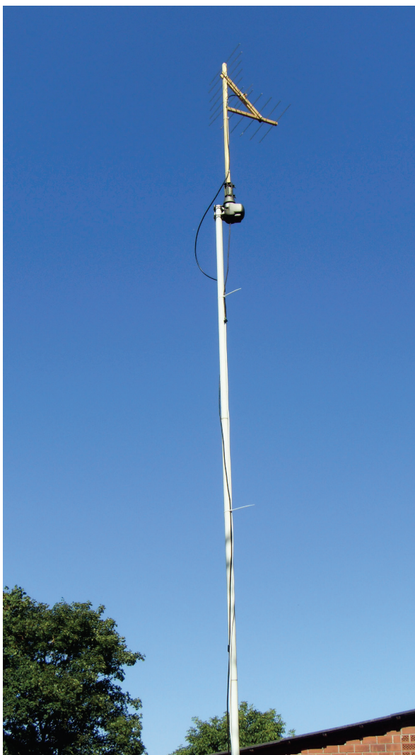
Abbildung 14: Corner-Antenne auf Mast mit Rotor
