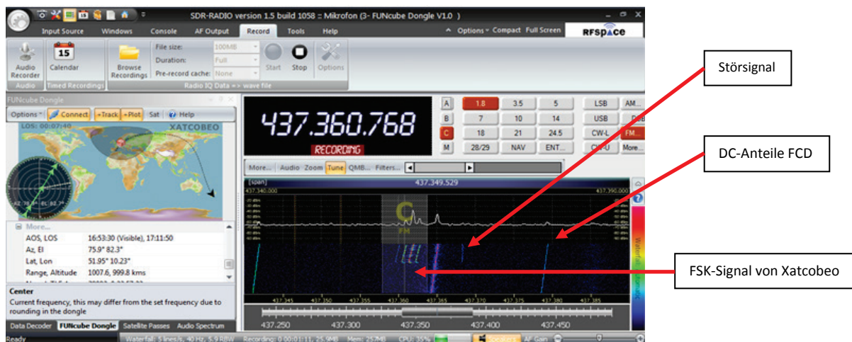
Abbildung 16: Hier sieht man bei abgeschalteter(!) Doppler-Kompensation die schief liegenden FSK-Signale des Satelliten Xatcobero und ein vertikales Störsignal.
