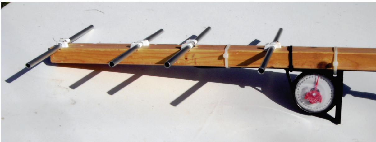
Abbildung 8: Die fertig gebaute Yagi-Antenne mit einfachem Winkelmesser zum Ablesen des Elevationswinkels
