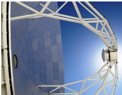
Hyperbolischer Gegenspiegel von ALMA (Bildquelle: ALMA (ESO/NAOJ/NRAO), Christian Castro/Las Últimas Noticias). https://cdn.eso.org/images/large/antennas-transp-01.jpg .
