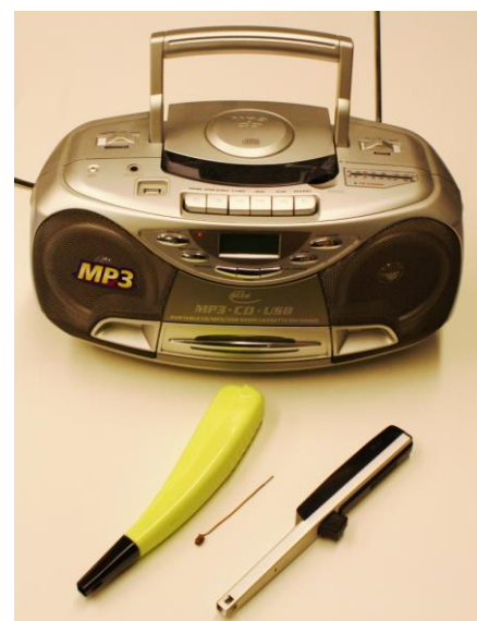
Abbildung 9: Radiostrahlung kann mit piezoelektrischen Gasanzündern erzeugt werden. Die Abstrahlung der Radiowelle verbessert sich durch eine kleine selbst gebogene Drahtantenne. ©: Olaf Fischer.
