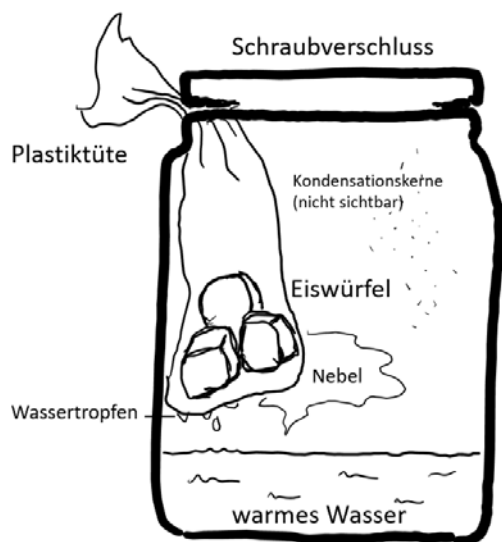
Abbildung 3: Versuchsaufbau Wolken herstellen (Abb. durch Autorin erstellt, CC0 1.0, https://creativecommons.org/publicdomain/zero/1.0/deed.de )
