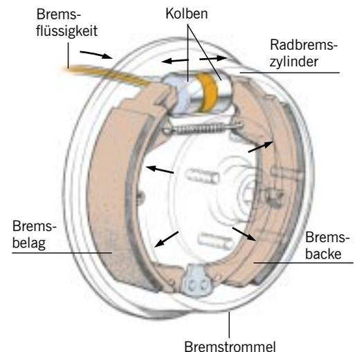
**Trommelbremsen** kosten weniger, leisten aber auch nicht so viel wie Scheibenbremsen. Sie werden deshalb gelegentlich für Hinterrad- oder Handbremsen verwendet. Zwischen den beweglichen Enden zweier Bremsbacken ist ihr Zylinder montiert. Bei Betätigung des Pedals werden die Backen durch die beiden Zylinderkolben gegen die Bremstrommel gepresst, die Bremsbeläge bremsen das Rad durch Reibung ab. Auf Grund ihrer größeren Fläche arbeiten Scheibenbremsen wirksamer.
