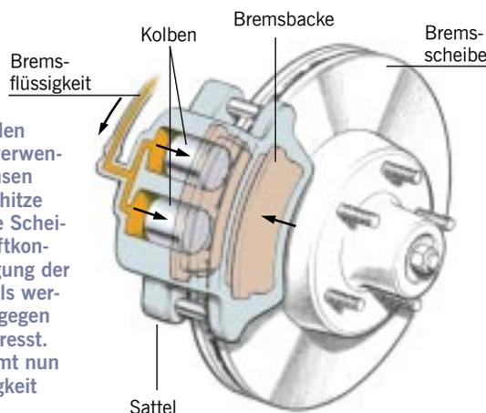
**Scheibenbremsen** werden meist für Vorderräder verwendet, um die beim Bremsen freiwerdende Reibungshitze schnell abzuführen (die Scheiben haben direkten Luftkontakt). Durch die Bewegung der Kolben des Bremssattels werden die Backenbeläge gegen eine Metallscheibe gepresst. Die Reibung verlangsamt nun deren Drehgeschwindigkeit und somit das Rad.
